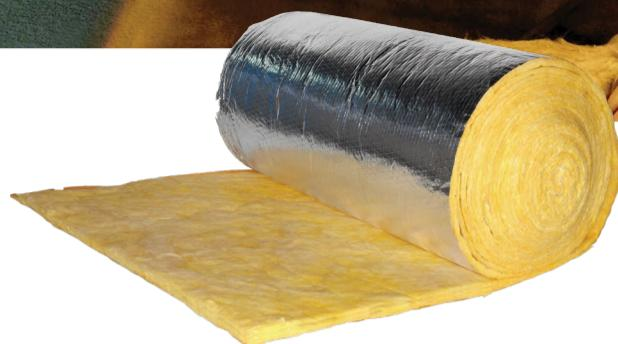
Duct Wrap™ es un aislamiento termoacústico presentado en rollo fabricado con fibra de vidrio aglutinada con resina, para soportar temperaturas hasta 232°C (450°F).
