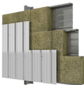
AISLACIÓN MURO METÁLICO
