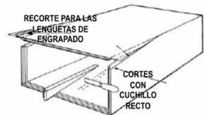
3.-Cierre el extremo pequeño de la transición, engrape las lengüetas y encinte. Si exist e demasiada disminución del panel oblicuo, encinte un panel de relleno en la transición como se muestra.
