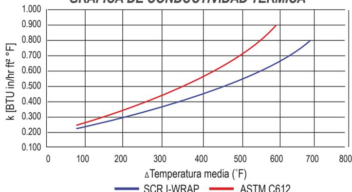
Δ Temperatura Media: Temperatura promedio de la temperatura de operación del proceso y la temperatura de superficie del aislamiento. Si requiere medidas especiales, favor de consultar a nuestro Departamento de Ventas de Owens Corning. Curva de conductividad térmica aparente determinada de acuerdo con la Práctica C 1045 de ASTM con los datos obtenidos por el Método de ensayo C177 de ASTM. Los valores son nominales y están sujetos a las tolerancias normales de ensayo y fabricación.
